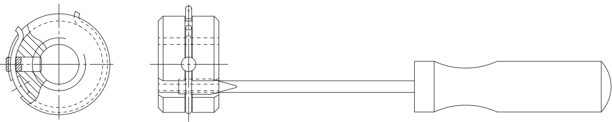
Abb. 4: Lösen der Arretierung der Anschlagmutter
