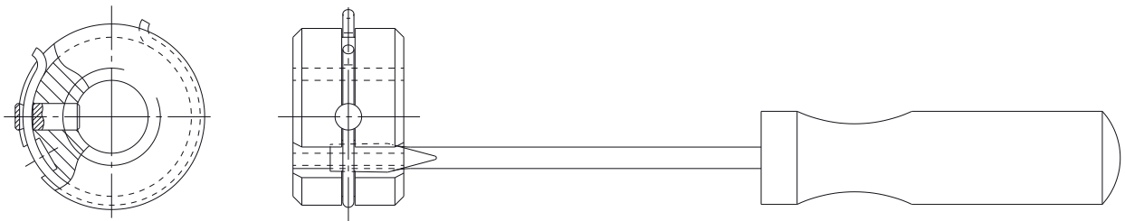
Abbildung 10: Montage Anschlagmutter bis SKG16
