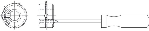
Abb. 4: Lösen der Arretierung der Anschlagmutter
