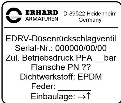
Bild 1.8 Standard-Typenschild
