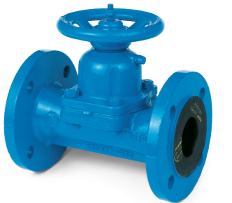
Membran-Absperrventil FD gummiert mit freiem Durchgang und Handrad
